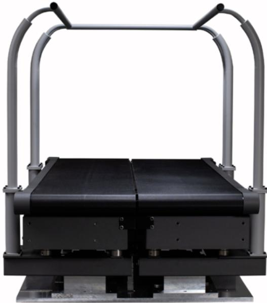
**Diseño único:** Diseñado meticulosamente, el treadmill de BERTEC es un sistema de correa dividida con cada lado controlado independientemente (o sincronizado) en ambas direcciones, hacia adelante y hacia atrás. Con pasamanos instrumentados opcionales y sistemas de inclinación, puede ampliar sus estudios para recopilar más escenarios, incluidas las fuerzas de la parte superior e inferior del cuerpo en configuraciones cuesta arriba o cuesta abajo.
